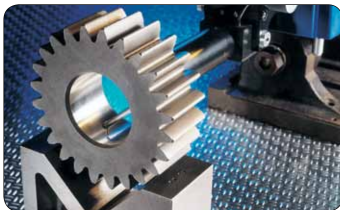
形状誤差は組立て時に問題を引き起こし、効率低下やパーツの早期故障を招く
