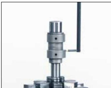
オプションのラジアル真直度ユニットを使用することでフォローモード測定が可能です。フォローモードは、カム形状のようなゲージ範囲を超える測定でもアームが自動追従し、測定を完了させます。この機能により、テーパ、スプライン、カムシャフト、CVジョイントなどの測定が可能になります。
