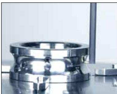
独自の最先端ゲージにより、4mmの範囲で測定可能です。単一のゲージで、真円度、輪郭、粗さ測定が可能になります。
