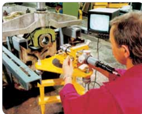
ディーゼルエンジンのアライメント (ここではCCTVシステム137-2161-01 を使用しています)
