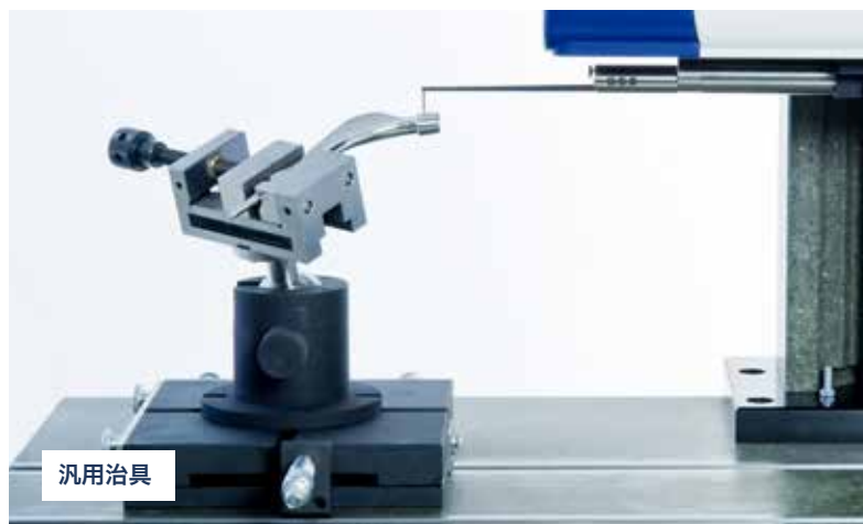
ライトアングルアタッチメントを使用した隅肉半径の測定
