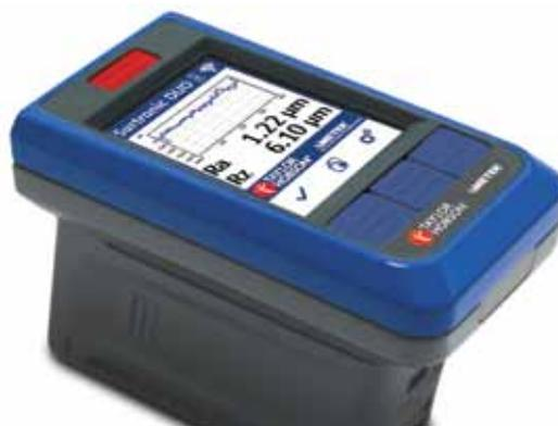
イントラ タッチ は、粗さ、うねり、輪郭を測定します。製造現場におけるハイレベルな表面性状解析に最適の低コストなポータブルシステムです。
