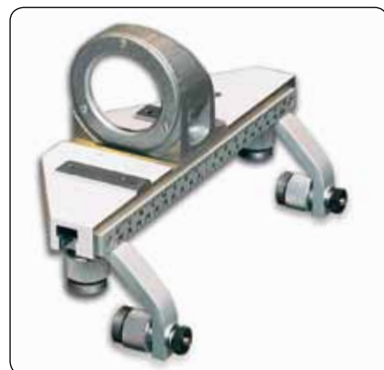
真直度の2軸測定用にサイドフィートを取り付けたアジャスタブルベース。その上にリフレクタを設置。
