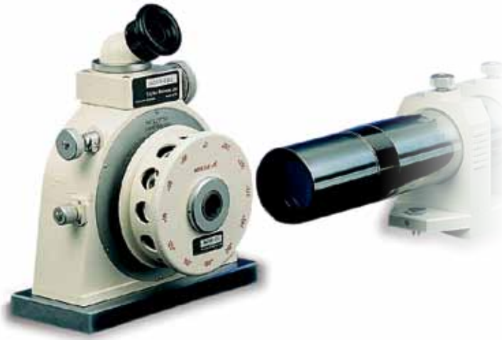
TA51でクリノメータTB100を検査
