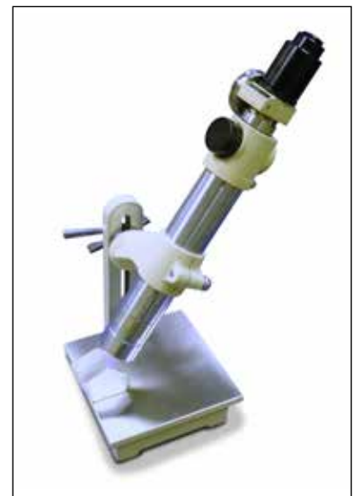
VA900オートコリメータとベースに示されているCCTV (ViVi) システム
