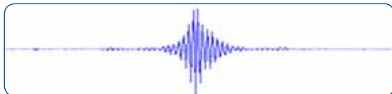
图7：单个像素点测量270纳米的薄膜
