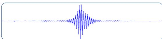
膜厚が1.5  $\mu\text{m}$  未満の場合(屈折率による)、干渉縞に歪みが生じるため、厚膜測定法では厚みを測れません(図7)。別の方法を使う必要があります。
