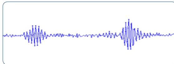
膜厚は、その2つの干渉縞のピーク位置を突き止め、屈折率を適用することによって確定されます。さらに、個々の干渉縞から、2つの界面(空気/膜と膜/基板)の表面情報を得ることも可能です(図5)。
